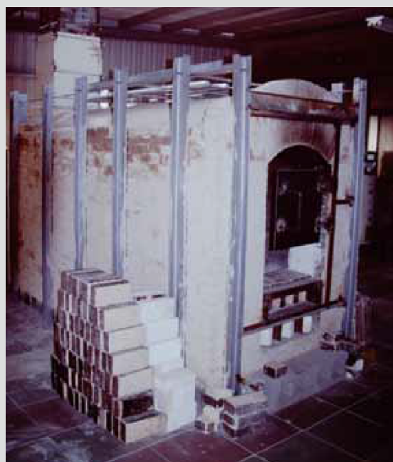
筆者在建築物頂樓砌築改良式柴窯（1999年）
